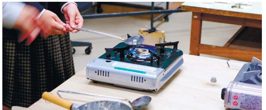
▲ホワイトメタルを使った簡易鋳造(インテリア・プロダクトデザインコース)
